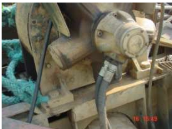
Troca de Mangueiras Hidráulicas
