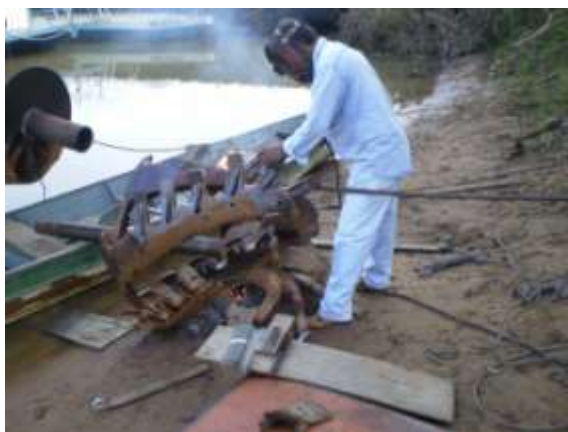
Reforma do Desagregador
