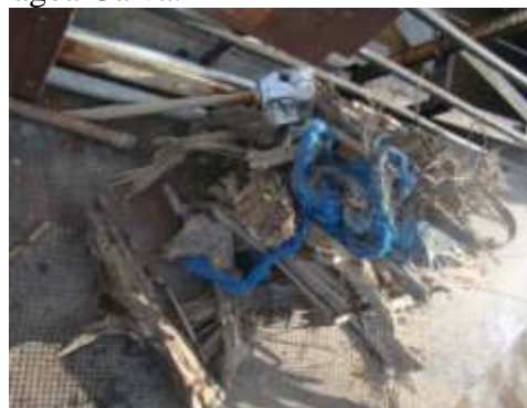
Materiais retirado do desagregador
